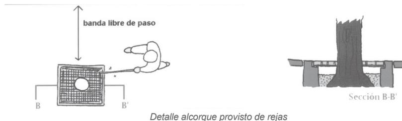
En el caso de construirse alcorques para el arbolado, éstos serán de forma cuadrada o circular, con dimensión mínima de anchura o diámetro de un metro (1 m.), manteniendo una separación en planta entre centros de alcorques entre 4,50 metros y 6,50 metros dependiendo de las especies a plantar, concitando el respeto a los vados y accesos existentes o proyectados con la necesidad estética y ordenación regular.
